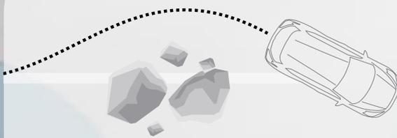
**Vehicle Dynamic Control** (Control Dinámico del Vehículo) te ayuda a mantenerte en la dirección que quieres ir. Monitorea tu forma de manejar y frenar y la compara con el trayecto del vehículo. Después reduce la potencia del motor y/o aplica los frenos en ciertas ruedas para ayudarte a mantenerte en tu camino.
